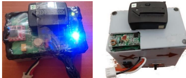
Figura 3.10 Colocación del sensor Delsys en el dispositivo maestro y esclavo para la obtención de las señales utilizadas en la caracterización.
