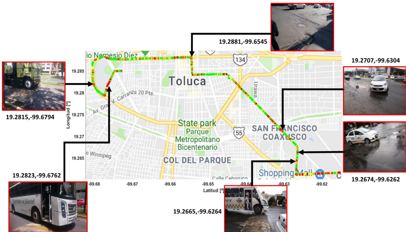
Figura 5.13 Localización de puntos de geolocalización reincidentes con niveles de vibración en la zona de peligro, los puntos se obtuvieron con el promedio de los 3 ejes del sensor en el piso.
