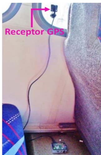
Figura 4.3 Colocación física del dispositivo maestro (sensor en el piso).
