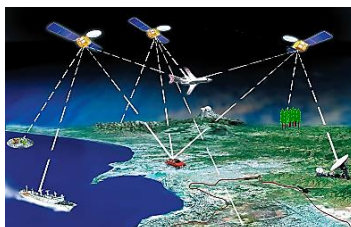
Figura 1.9 Descripción grafica del funcionamiento del sistema GPS (Imagen modificada de [68]).
